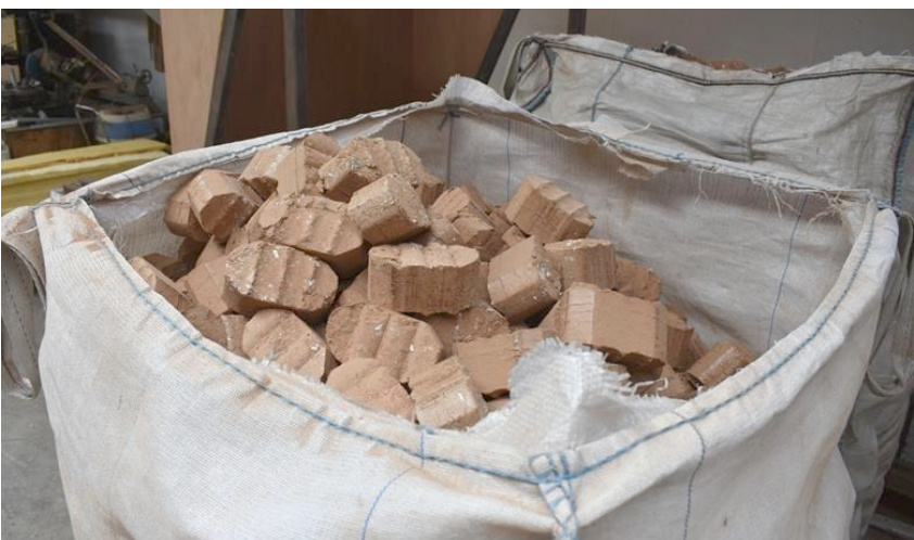
Al het houtafval wordt samengeperst tot briquetten om de zaak te verwarmen in de winter
